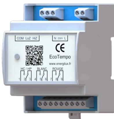
Le module ECOTEMPO est une interface de décodage des signaux TIC (Télé-Information Client) des compteurs intelligents LINKY. Il agit sur 3 contacts secs inverseurs selon les tranches tarifaires en cours.
